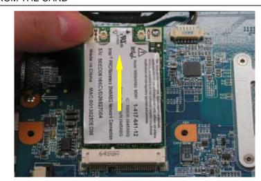
LIFT THE SIDE OF THE WIRELESS CARD UP. REMOVE THE CARD AWAY FROM THE SOCKET
