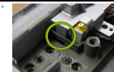
RELEASE THE CLIP ON EACH SIDE OF THE RJ-11 /RJ-45 BRACKET AND LIFT THE BRACKET UP
