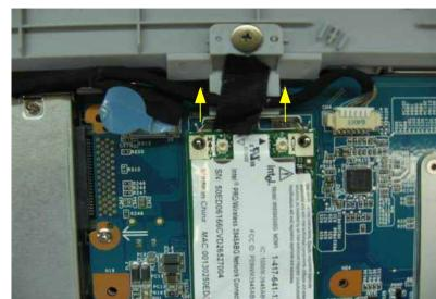
RELEASE THE WIRLESS CARD BY PRESSING THE TWO CLIPS AWAY FROM THE CARD
