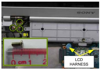
DISCONNECT THE TWO CONNECTORS ON THE LCD HARNESS. REMOVE THREE SCREWS FROM THE LEFT HINGE
