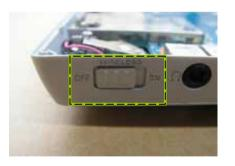
WHEN INSTALLING THE MOTHERBAORD. ENSURE THE WIRELESS LAN SWITCH ON THE MOTHERBOARD IS IN THE SAME POSITION THE WIRELESS LAN SWITCH ON THE BOTTOM HOUSING
